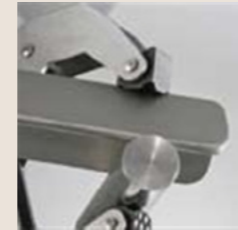
4 X-блок Подходит для захвата круглых деталей и угловых профилей.
