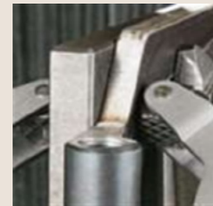
2 Шероховатая поверхность Увеличивает трение на поверхности прижима.
